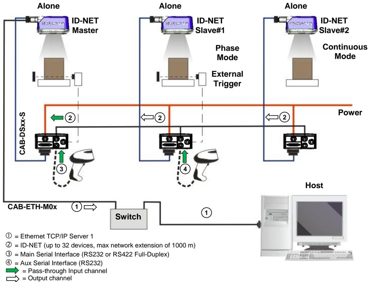
Figure 11 – ID-NET Multidata Layout (Pass-through)
